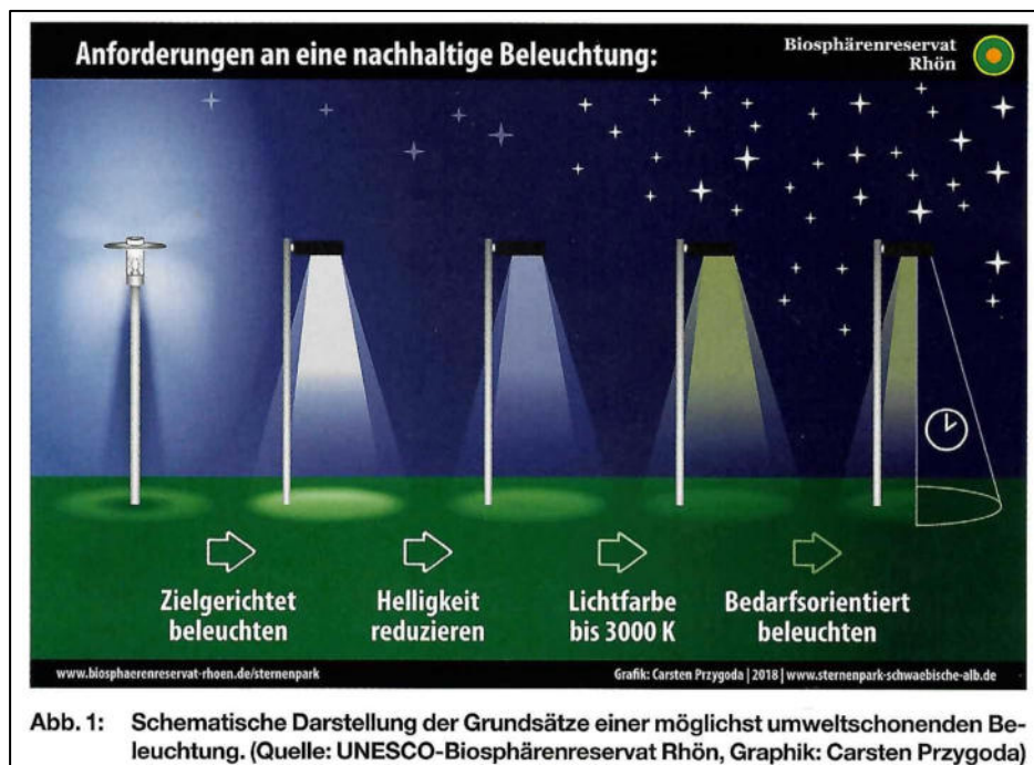
Abb. 7: Umweltschonende Beleuchtung (Abbildung aus FRANK et al. 2023).
