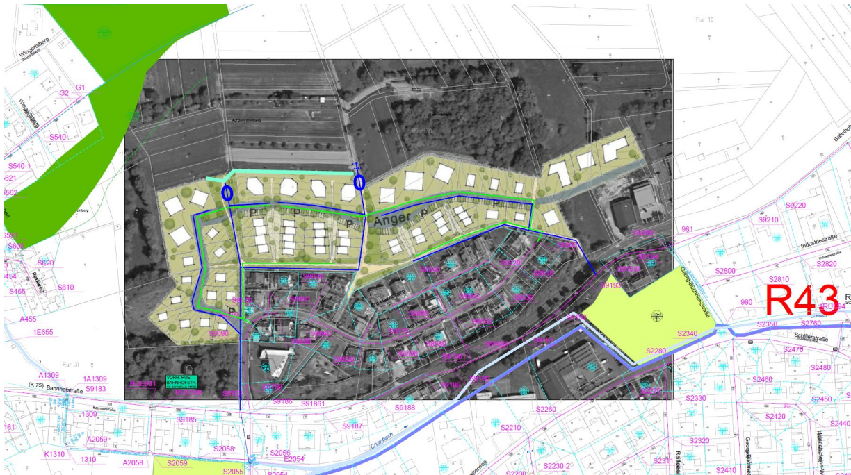
Konzept Hochwasserschutz und Entwässerung (Reitzel, 2022)
