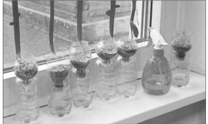
*Mini-Kläranlagen im Praxistest: Aus einer PET-Flasche und dem richtigen Filtersubstrat kann mit wenigen Handgriffen eine kleine Einheit gebaut werden, die aus dem Wasser grobe Verunreinigungen herausfiltert.*
